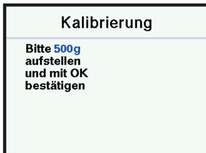
Sobald das Gewicht eingestellt und in Ruhe ist, wird über den Drehregler-Taster die Kalibrierung durchgeführt und das Menu verlassen.
